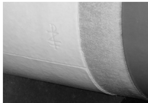
↑ 02 Das Wasserzeichen in der Aufsicht unmittelbar nach dem Schöpfvorgang mit dem Rundsiebzyylinder. Das Papier ist noch naß und die Vertiefung plastisch erlebbar.
