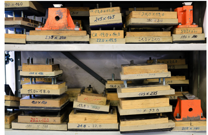
↑ 01 Matrizen und Matrizenhalter für den Dreimesserautomaten
