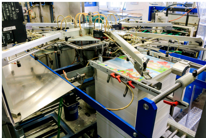
↑ 02 Drehstern für die Bogenvereinzelnung
